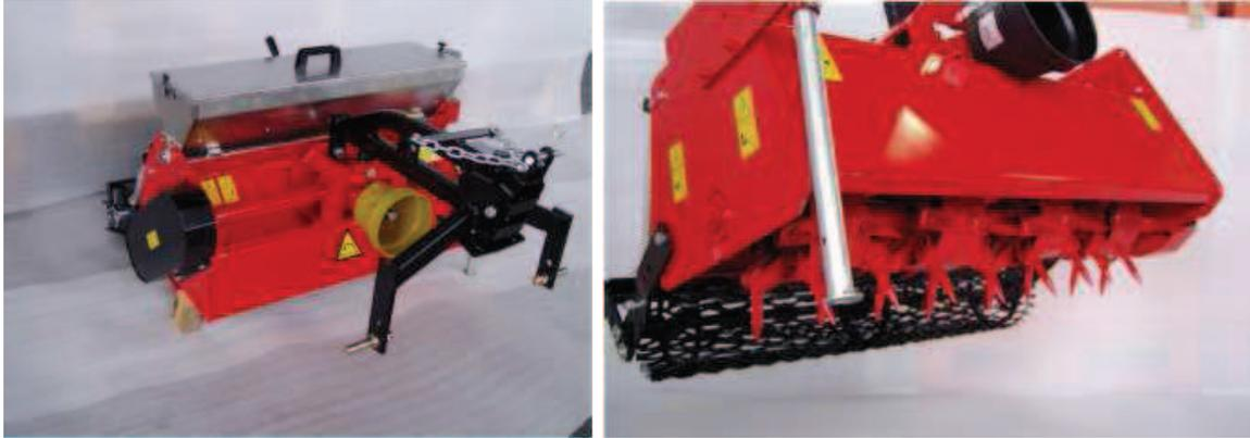
La RYGEN è una macchina combinata che provvede ad eseguire in una sola passata lavorazioni plurime e cioè l'aerazione del prato, la risemina dell'erba (o la concimazione) e la rullatura.
