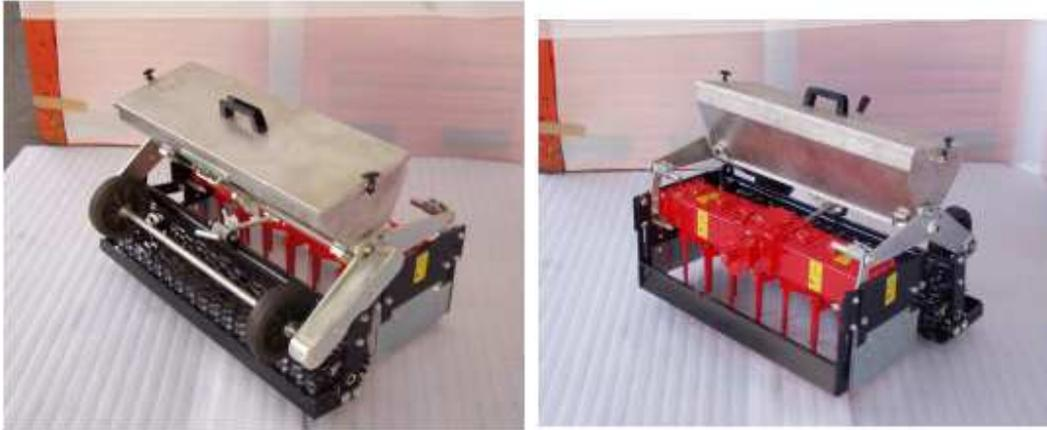
Cet outil permet de semer ou épandre l'engrais sur le terrain après le défrichage.
