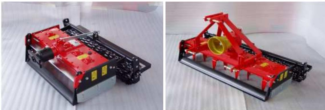
L'erpice mod. **ZIP** è stato progettato per le piccole aziende agricole e per le lavorazioni del terreno in colture specializzate come ortofrutticole e viticole. La particolare attenzione al dimensionamento della macchina, il peso contenuto ne fanno una attrezzatura indicata per trattrici di bassa potenza. Il particolare disegno dei coltelli consente uno sminuzzamento del terreno con una sensibile economia del trattore o del motocoltivatore.
